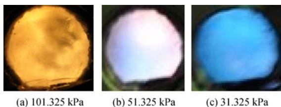
图12 改进火焰筒不同进口空气压力下的火焰形态
